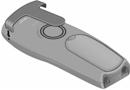
Den Gürtelclip auf der Rückseite des Mobilteils andrücken, bis die seitlichen „Nasen“ in die Aussparungen einrasten.
