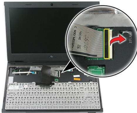
6. Trennen Sie das Tastaturkabel von seinem Anschluss auf der Systemplatine.
