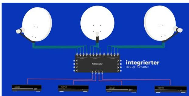
Mit Hilfe eines Multischalters kann eine einzige DiSEqC-Anlage von mehreren Teilnehmern genutzt werden. Multischalter haben je nach Hersteller unterschiedlich viele Teilnehmerausgänge. Das Signal kann anschließend kaskadiert werden, um es so beliebig vielen Teilnehmern zur Verfügung zu stellen.
