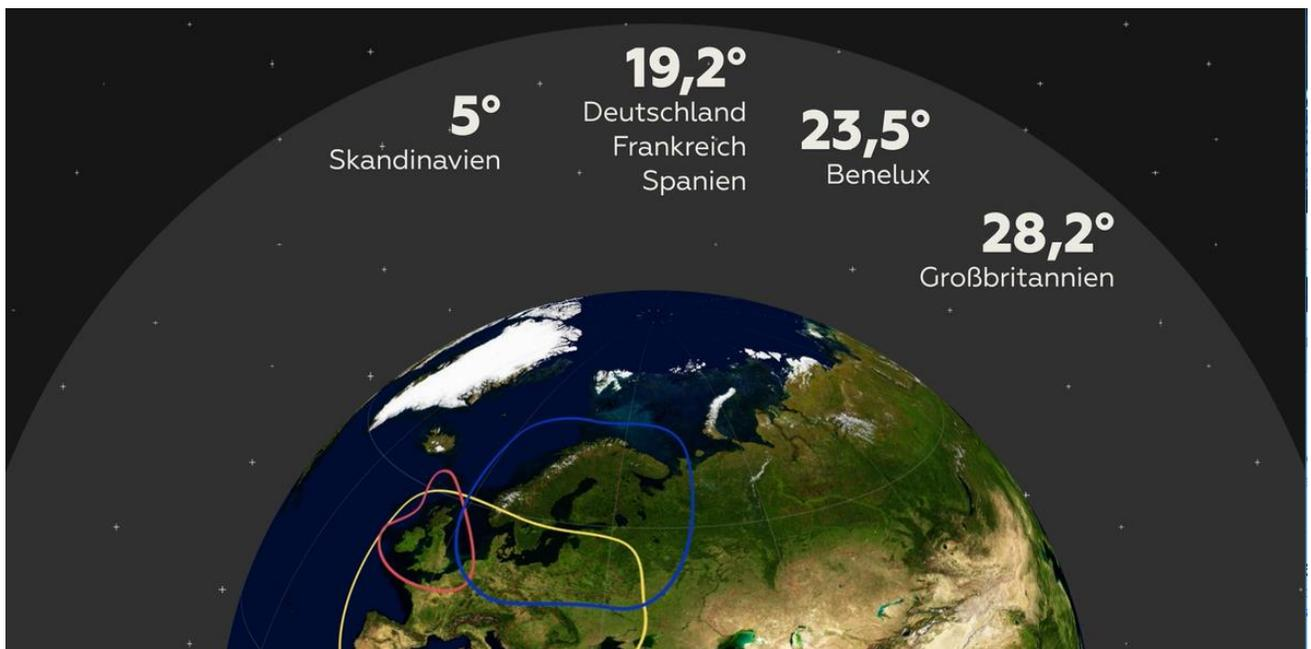
Eine Möglichkeit hierfür ist der sogenannte Multifeed oder der schielende Empfang. Er basiert auf der Tatsache, dass der Spiegel einer Satellitenschüssel mit mehr als einem LNB bestückt werden kann. Jeder LNB in der Schüssel zeigt dabei auf eine andere Satellitenposition.
