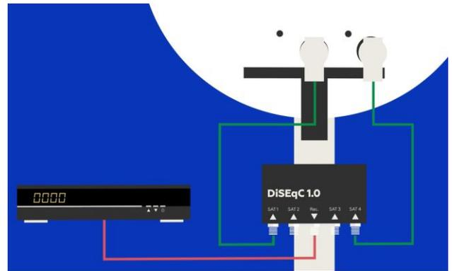
In einer normalen Installation können mit den DiSEqC-Schaltbefehlen bis zu vier Satellitenpositionen angewählt werden.
