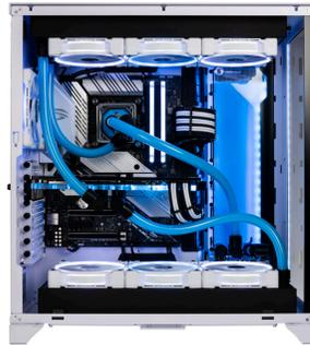
Einbauplätze für Radiatoren bieten. Das Lian Li *O11Dynamic XL* zum Beispiel kann gleich drei große 360-mm-Radiatoren beherbergen und hat noch Platz für einen großen Ausgleichsbehälter. Alternativ kann neben dem Mainboard auch eine eigens angefertigte Distroplate von Lian Li montiert werden.
