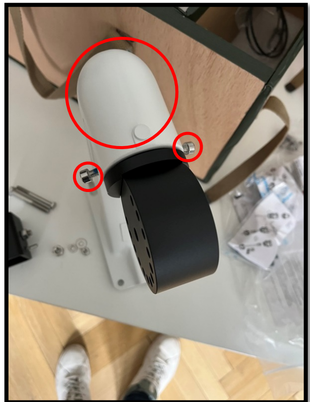
Kamerahals und seitliche Schrauben
