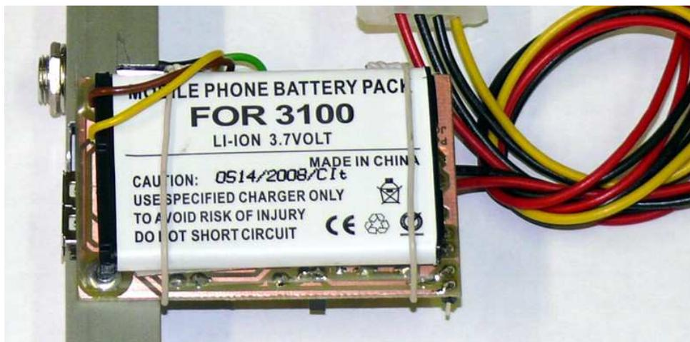
Als Ladekontroller wird ein „MAX1811“ verwendet. Der Ladekontroller arbeitet vollautomatisch, der Akku wird daher auch nicht überladen (Ladeschlussspannung beachten). Es stehen hier zwei Dip-Schalter zur Verfügung mit denen man den Ladestrom und die Ladeschlussspannung einstellen kann.
