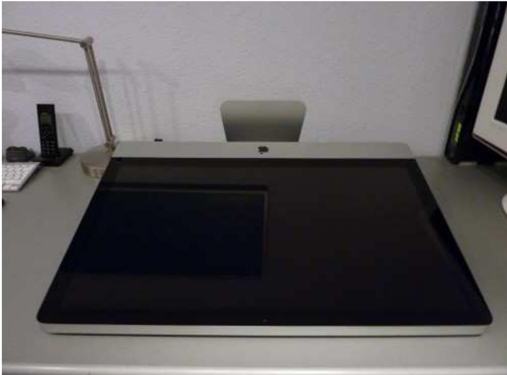
Nun die Glasheber an der Oberkante des Displays anbringen, also auf der Seite, wo die iSight sitzt, dann mit leichtem Kraftaufwand die Scheibe nach oben ziehen, sie wird nur durch Magneten gehalten.
