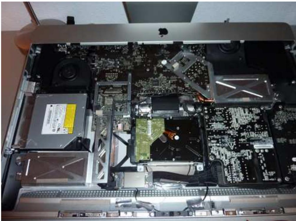
Am Superdrive sitzt ein Aufkleber mit einem Temperatur-Sensor, dieser ist nur geklebt und kann leicht abgezogen werden, danach kann das Drive mit 4 Schrauben einfach und mühelos entfernt werden.
