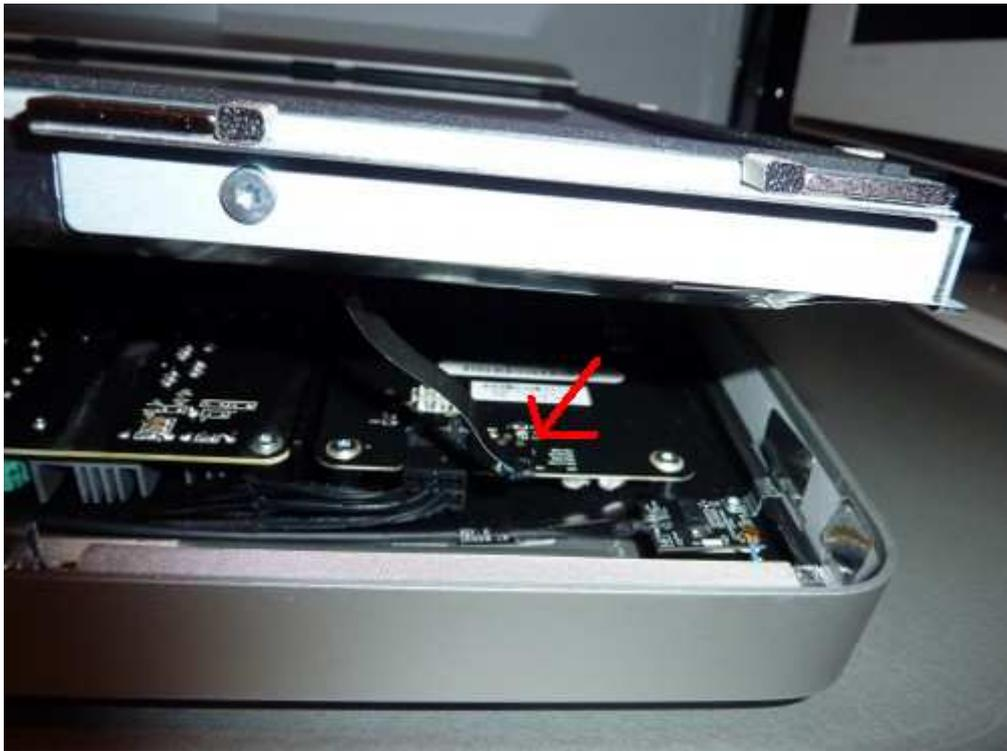
Direkt vorne rechts sitzt das erste Flachbandkabel, welches aus der Steckverbindung vom Board gelöst werden muss, dazu nehmt am besten eine Flachzange oder flache Pinzette. Ist das Kabel gelöst, gibt es hinten das nächste zu lösende Kabel, welches aber per Stecker verbunden ist.
