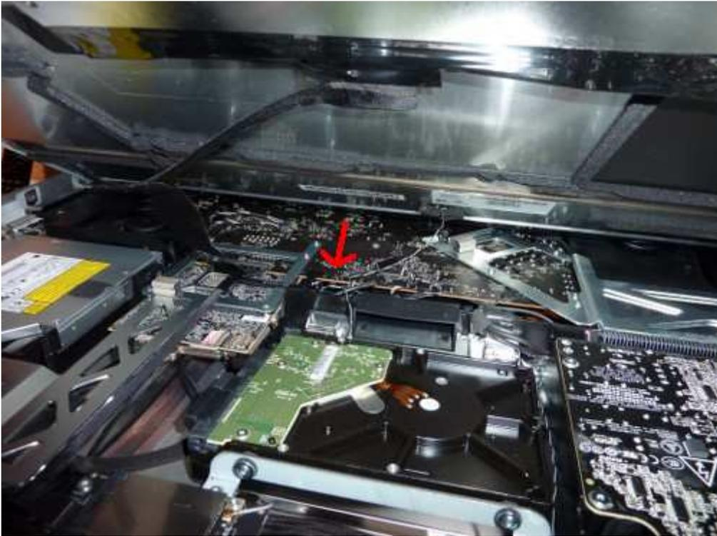
Und am Ende das vierte Kabel (Stecker) lösen:
